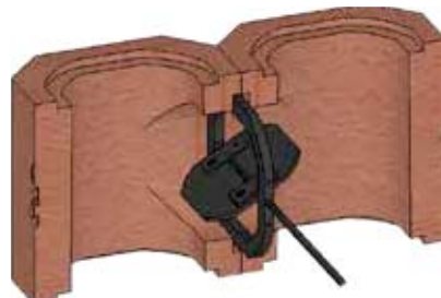
Aanmaakklep vierkante as 8 x 8 mm
